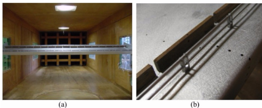
Figura 2. (a) Modelo seccional para medida de pressões nos tabuleiros no interior do túnel de vento e (b) detalhe da instrumentação com tomadas de pressão.
