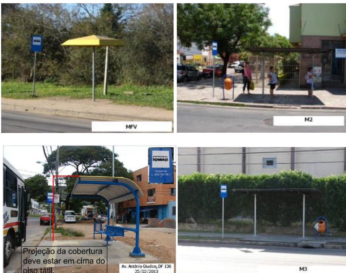
Figura 5.23 - Exemplos de Tipo de Cobertura.
